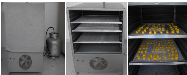
Figura 6 - Desidratador de frutas Polidryer PD- 25.
